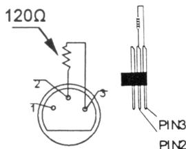
Een DMX eindweerstand is aanbevolen als de DMX-kabel vrij lang is of wordt gebruikt in een omgeving met veel elektrische ruis (bv. een discotheek). De eindweerstand voorkomt corruptie van het digitale controlesignaal door elektrische ruis. De DMX eindweerstand is niets meer dan een XLR-stekker met een weerstand van 120 Ω van pin 2 naar 3. Deze XLR-stekker wordt dan aangesloten op de XLR-uitgang van het laatste toestel in de reeks. Zie de illustraties links.
