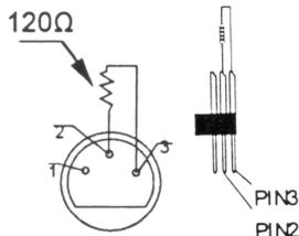
Se recomienda una terminación si el cable DMX debe cubrir una gran distancia o si se usa en un medio ambiente con mucho ruido eléctrico (ej. una discoteca). La terminación impide que el ruido eléctrico corrompa la señal de control numérico. La terminación DMX no es más que un conector XLR con una resistencia de 120Ω de polo 2 a polo 3. Este conector XLR está conectado a la salida XLR del último aparato de la serie. Véase la figura a la izquierda.
