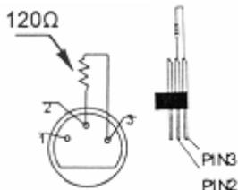
Es empfiehlt sich eine DMX-Terminierung wenn das DMX-Kabel eine große Distanz überbrücken muss oder in einer Umgebung mit vielem elektrischen Geräusch verwendet wird (z.B. Diskothek). Die Terminierung verhindert Korruption des digitalen Kontrollesignals durch elektrisches Geräusch. Die DMX-Terminierung ist nur ein XLR-Stecker mit einem Widerstand von 120Ω zwischen Pol 2 und Pol 3. Dieser XLR-Stecker wird dann in den XLR-Ausgang am letzten Gerät gesteckt. Siehe Abbildung links.
