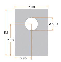
Silikonfolien (glasfaserverstärkt) dienen in Verbindung mit Isolierbuchsen zur isolierten Montage von Halbleitern z.B. auf Kühlkörpern.
