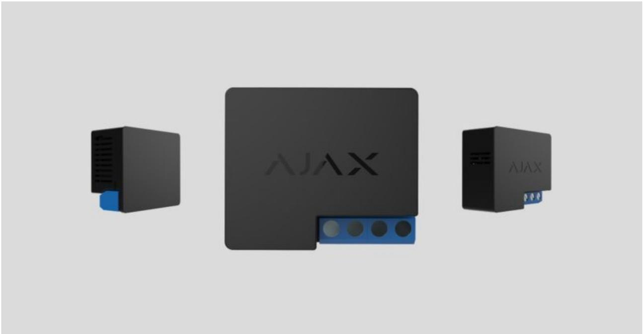
**Relay** ist ein fernsteuerbares Niederspannungsrelais mit potentialfrei (trocken) schaltenden Kontakten. Das Relay kann mit Steuerspannungen von 7 bis 24 V= geschaltet werden. Relay kann sowohl im Impulsmodus als auch im bistabilen Modus betrieben werden. Das Gerät kommuniziert über das Jeweller-Funkprotokoll mit einer Hub-Zentrale. In Sichtlinie beträgt die Übertragungreichweite bis zu 1000 m.
