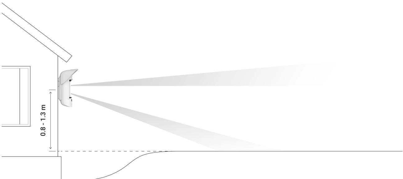
**Zur Erfassung kriechender Einbrecher kann der Melder 50 cm über dem Boden** angebracht werden. Allerdings ist in diesem Fall die Funktion zum Ignorieren von Haustieren nicht verfügbar. Diese Montagehöhe wird bei der Installation von Meldern in Industrieanlagen und Lagerhäusern empfohlen. Wichtig. Tiere dürfen den geschützten Anlagenbereich nicht betreten, da sie sonst Alarme auslösen
