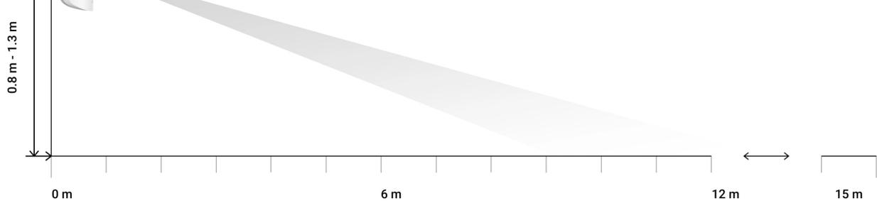
Der Erfassungsbereich wird mit dem Schieberegler Erfassungsreichweite (Detection Distance) auf der Rückseite des Melders eingestellt. Berücksichtigen Sie bei der Wahl des Montageortes den maximalen Erfassungsbereich des Melders. Er ist abhängig von der Empfindlichkeit, der Stellung des Schiebereglers "Erfassungsreichweite", der Art und Geschwindigkeit der Bewegung der Person (Laufen, Gehen) und der Umgebungstemperatur.
