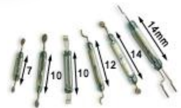
Offener Reedswitcher für SMD Montage mit flachen oder runden Anschlüssen
