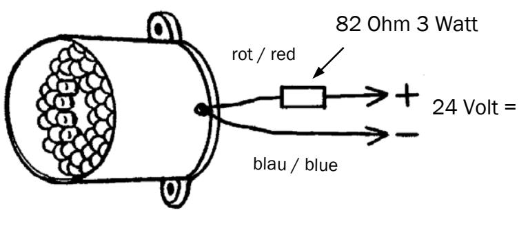
**D** Befestigung: Aufputz mit 2 Schraubösen. Betriebsspannung: 12V=, < 150mA, bei Verwendung des beiliegenden Vorwiderstands auch für 24V=. Maße: ca. Ø 51mm x 51mm lang.
