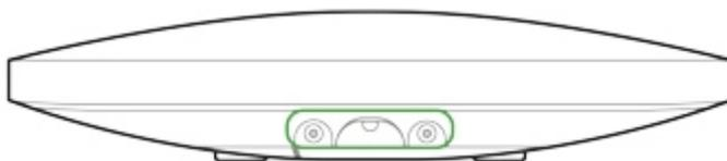
Drehen Sie die Hub-Zentrale nicht um, wenn er vertikal installiert wird (z. B. an einer Wand). Bei korrekter Montage wird das Ajax-Logo horizontal angezeigt.
