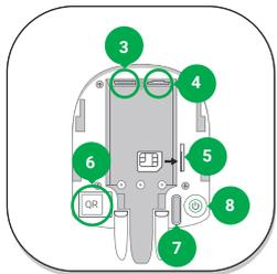
3 – Anschluss für Stromversorgungskabel
