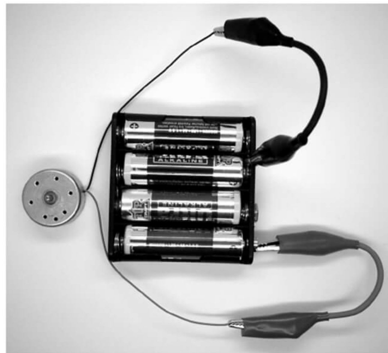
Abb. 2.8: Abgriff der Batteriespannung bei 3 V
