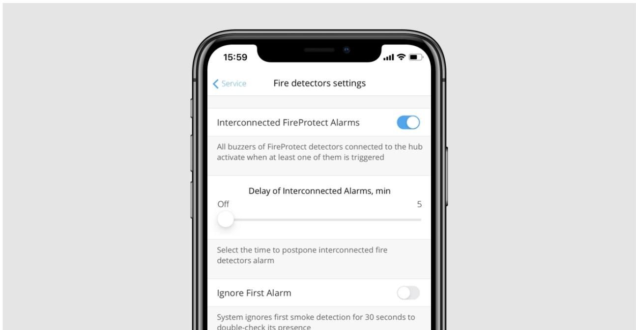
5. Aktivieren Sie bei Bedarf die Funktion **Ersten Alarm ignorieren**. Diese Funktion wird empfohlen, falls sich am Objekt eine potenzielle Quelle für Fehlalarme befindet. Diese können beispielsweise solche mit hoher Dampf- oder Staubentwicklung sein.
