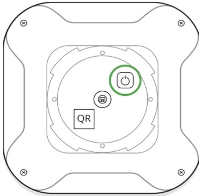
Um sicherzustellen, dass der Melder eingeschaltet ist, drücken Sie die Ein-/Ausschalttaste – das Logo leuchtet für eine Sekunde rot auf.
