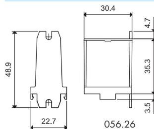
Der elektrische Anschluss erfolgt durch Löten und einer Schrumpfschlauch-Isolierung oder über isolierte Steckhülsen für (2x0,5) mm Faston.
