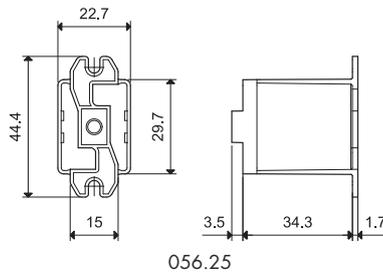
Der elektrische Anschluss erfolgt durch Löten und einer Schrumpfschlauch-Isolierung oder über isolierte Steckhülsen für (2x0,5) mm Faston.
