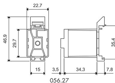
Der elektrische Anschluss erfolgt durch Löten und einer Schrumpfschlauch-Isolierung oder über isolierte Steckhülsen für (2x0,5) mm Faston.
