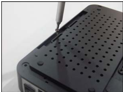
3. Die Schrauben am Unterteil des HD-Laufwerks fest anziehen, um die Festplatte zu befestigen (4 Kurzschrauben).
