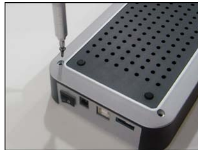
6. Drehen Sie Schrauben (2 längere, 2 kürzere) in das Unterteil des HD-Laufwerks ein, um es abzudichten.
