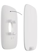
**10.** Befestigen Sie die Brandplate mit den beiliegenden Schrauben an der Kunststoffschutzplatte.
