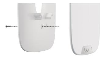
11. Bringen Sie die Kunststoffschutzplatte (das Ajax Logo auf der Anschlussseite des LED-Streifens an die Platine) mit wenig Kraft an. Die korrekt montierte Kunststoffplatte ragt nicht mehr als 1,0 bis 1,5 mm über den LED-Rahmen hinaus.
