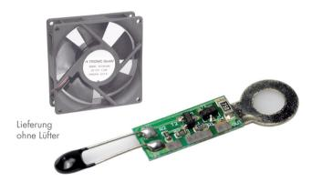
Diese automatische temperaturgeführte Steuerung ist für handelsübliche Gleichspannungs-Kleinlüfter (12 V) ausgelegt, so wie sie in fast jedem PC zur Kühlung eingebaut sind. Ein Temperaturfühler steuert die Lüfterdrehzahl in Abhängigkeit der Temperatur. Für Lüfter mit einer max. Stromaufnahme von 400 mA geeignet.
