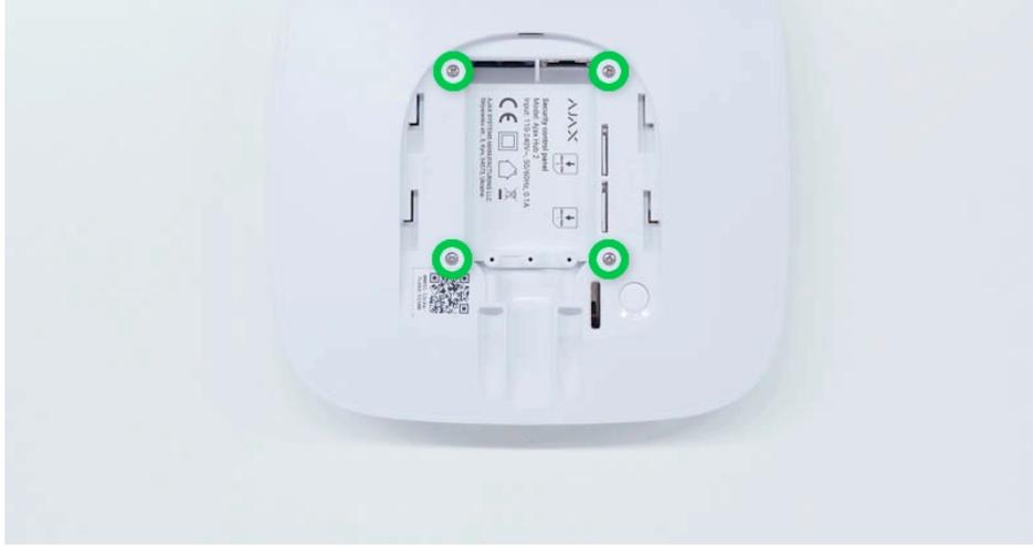
5. Entfernen Sie die Schrauben, mit denen die Platinen am Gerätegehäuse befestigt sind.
